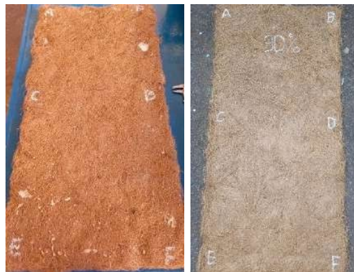
Gambar 5. Ketebalan Komposisi Kedua Sebelum dan Sesudah Di-Roll
