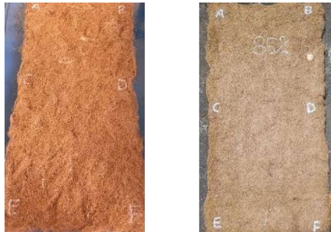
Gambar 8. Ketebalan Komposisi Ketiga Sebelum dan Sesudah Di-Roll
