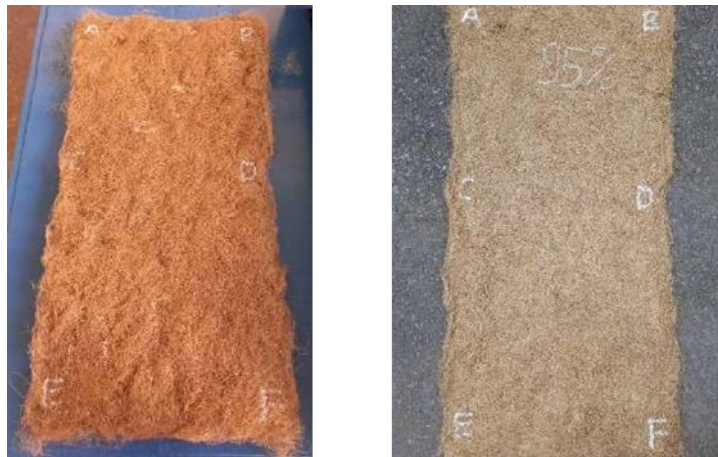
Gambar 2. Ketebalan Komposisi Pertama Sebelum dan Sesudah Di-Roll
